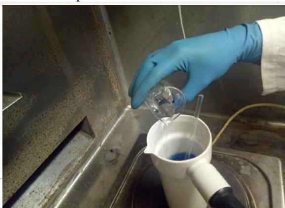
Рис 6 Приготовление медного купороса(электролита)
