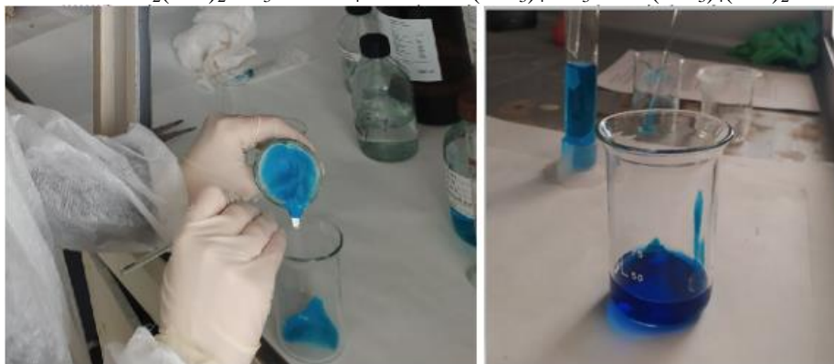
Рис. 6 Получение раствора гидроксида тетраамминмеди.
