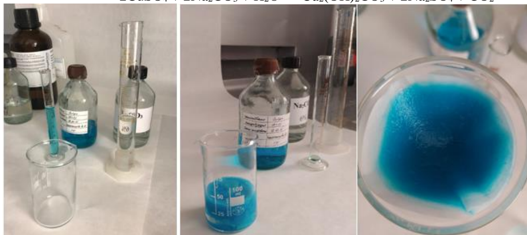
Рис. 5 Получение гидрокарбоната меди \text{Cu}_2(\text{OH})_2\text{CO}_3 .
