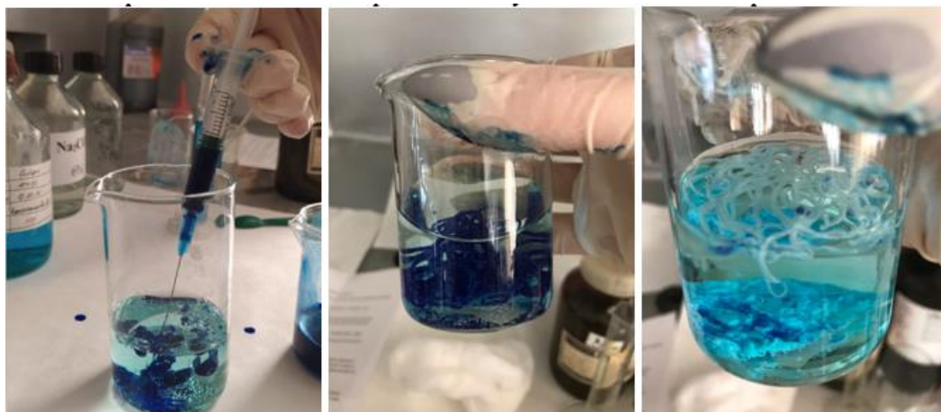
Рис. 7 Получение медно-аммиачного волокна.
