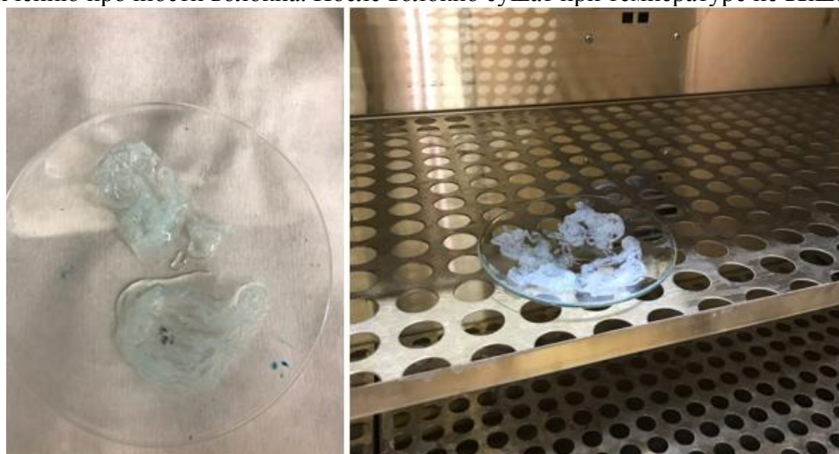
Рис. 8 Обработка глицерином и сушка медно-аммиачного волокна.
