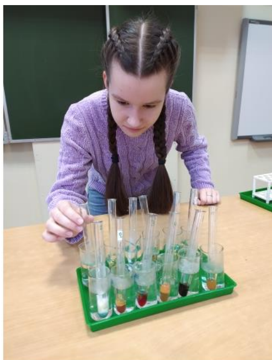
Фото 3. Приливаем ко всем исследуемым пробиркам \text{CuSO}_4 и \text{NaOH} . Ставим пробирки на водяную баню
